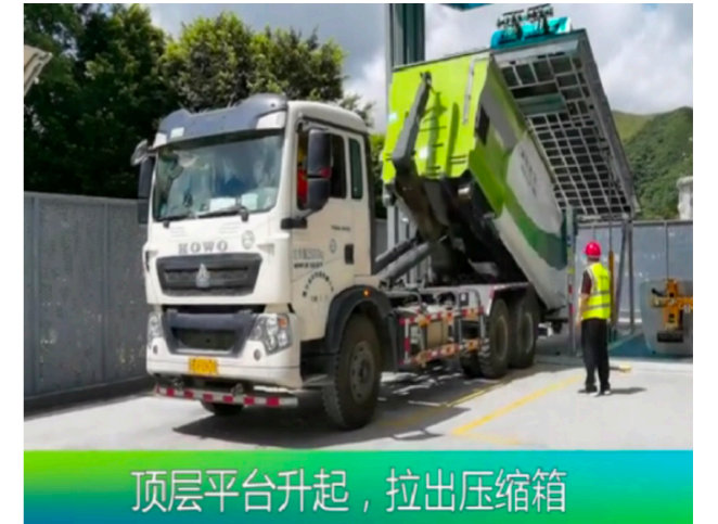
图11 顶层平台升起，勾臂车拉出压缩箱
