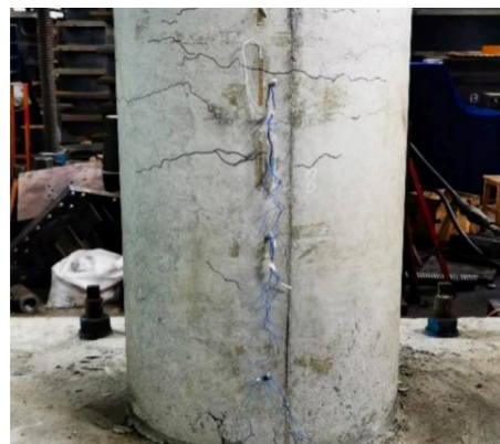
(a) 内壁锯齿形槽口新型连接方式墩身裂缝分布
