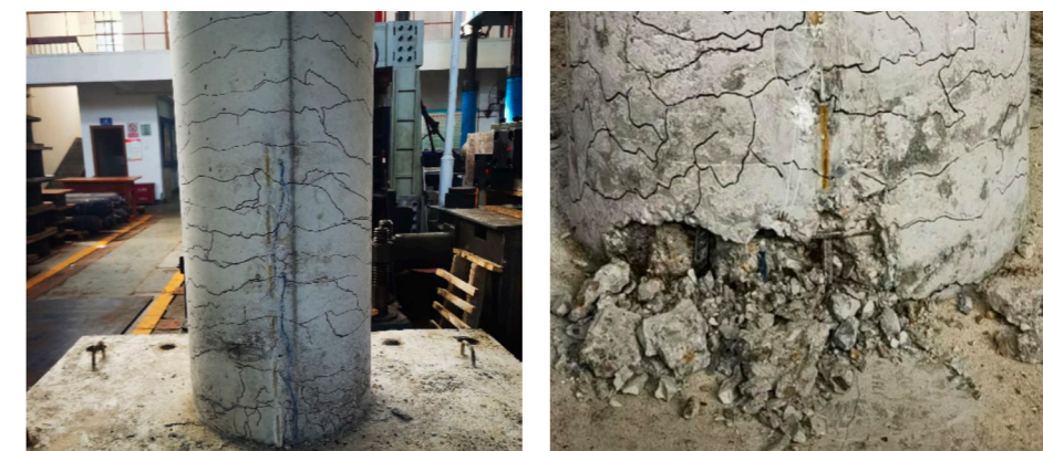
(a) 现浇墩身裂缝分布
