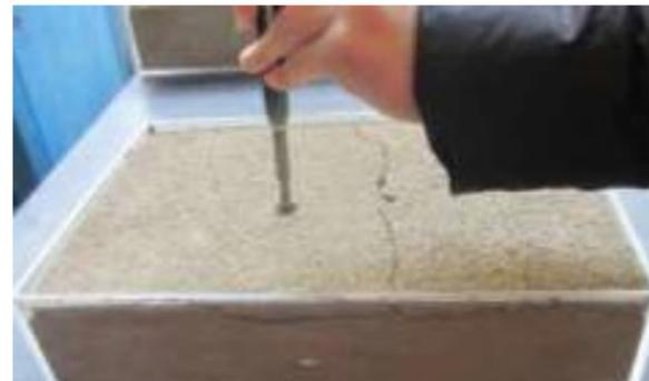
图4 微生物加固土样表面强度检测
