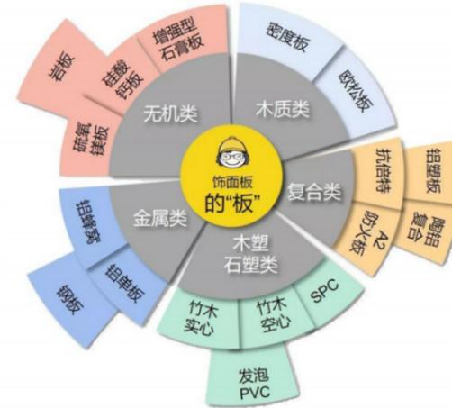
图4 装配式部品材质示意
